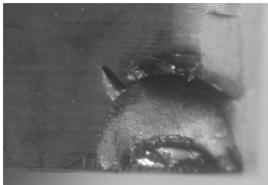
Obr. 5.10 Lom břitu nástroje [17]
